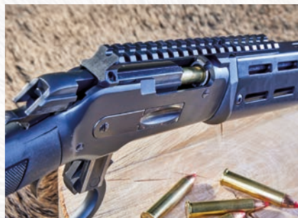
Der tiefer ausgeschnittene Systemgehäuse-Rand der Chiappa 1886 Tactical Wildlands T.D. Angle Ejection ist ein wesentliches Element bei der Montageschiene- und ZF-freundlichen A.E.-Funktion, als deren Folge die Hülsen beim Auswurf nicht lotrecht nach oben steigen, sondern zur Seite umgeleitet werden.
