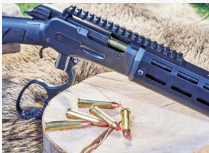
Der tiefer ausgeschnittene Systemgehäuse-Rand der Chiappa 1886 Tactical Wildlands T.D. Angle Ejection ist ein wesentliches Element bei der Montageschiene- und ZF-freundlichen A.E.-Funktion, als deren Folge die Hülsen beim Auswurf nicht lotrecht nach oben steigen, sondern zur Seite umgeleitet werden.
