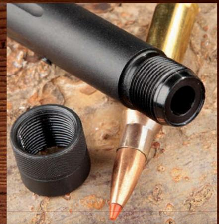
Eine halb gerändelte Überwurfmutter schützt das 5/8-24-UNEF-Mündungsgewinde der BA13TD vor Schäden.
