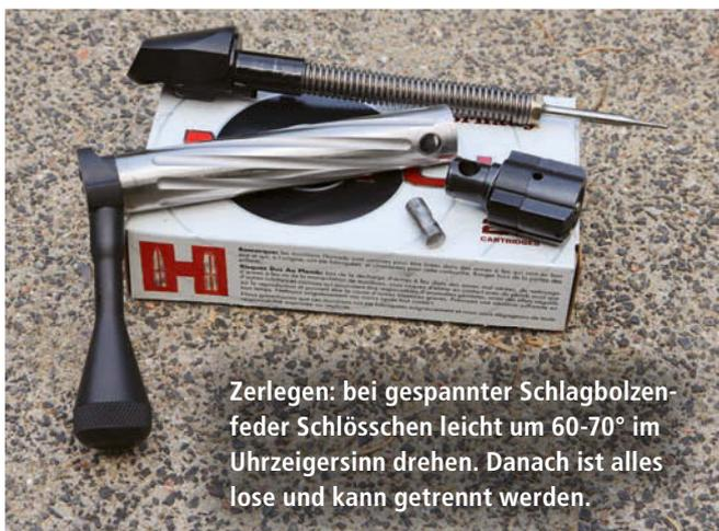
Zerlegen: bei gespannter Schlagbolzenfeder Schlüsschen leicht um 60-70° im Uhrzeigersinn drehen. Danach ist alles lose und kann getrennt werden.
